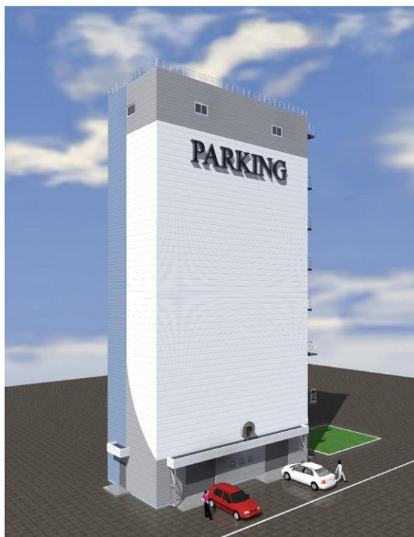
Конечно, главное преимущество механизированной стоянки - компактность. Отсутствие подъездных пандусов и прочих архитектурных элементов, необходимых для бетонных многоярусных гаражей позволяет размещать эти парковки в местах плотной застройки. К тому же внешний облик таких строений вполне отвечает требованиям современного техногенного дизайн, столь активно распространяющегося в современных городах.
